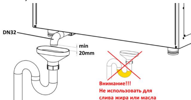
Рисунок 11 - Подключение к системе канализации
